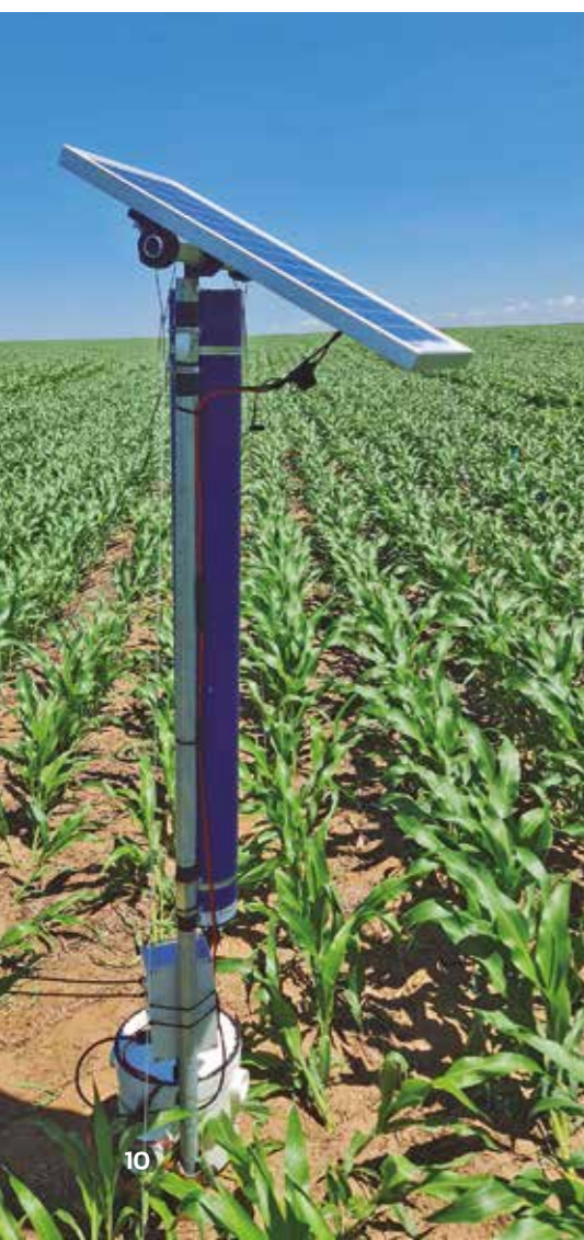
Sensor de nêutrons de raios cósmicos (cilindro azul) em lavoura em Luís Eduardo Magalhães (BA). Um painel fotovoltaico gera a energia para o conjunto de dispositivos.
