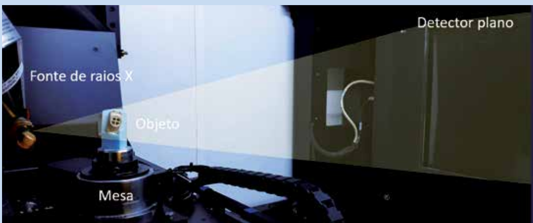
Fig. 1: Configuração típica de SMTRX com seus três principais subsistemas e uma peça de titânio no campo de radiação.
