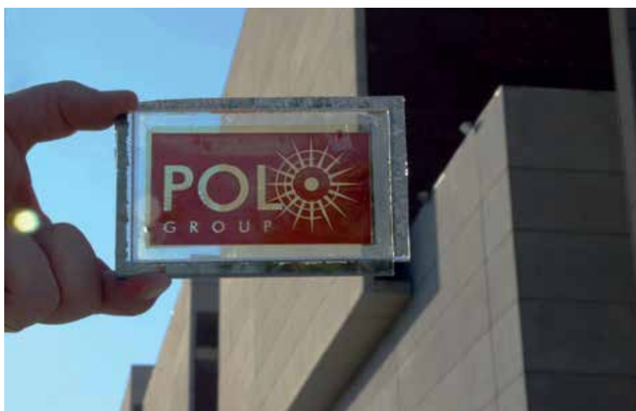
Célula solar sensibilizada por corante preparada na UFABC.
